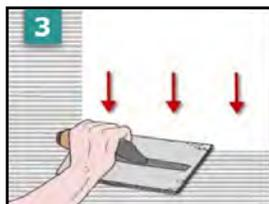
**3 APLANAR:** **Importante -** Ligeramente derribar las partes superiores del mastiche peinado con el borde plano de la llana hasta que quede liso.
