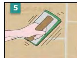
Usar un flotador de goma y golpee ligeramente sobre la superficie del azulejo para lograr adherencia completa.
